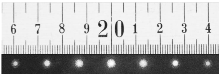
M8: Interferenzbild mit Maßstab in cm. Der Abstand zwischen Gitter und Schirm beträgt 0,85 m und die Wellenlänge des Lasers 633 nm.
